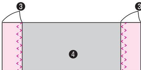
**2 Doba ambos extremos 2 cm respectivamente. Cosa los bordes doblados con puntadas en zigzag de 2 pasos (ancho de zigzag 0,7 cm, largo de puntada 0,1 cm).**
