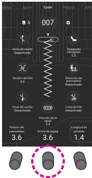
Cambie el ancho del zigzag **A** girando el dial de ajuste ubicado debajo de la indicación [Ancho de zigzag].
