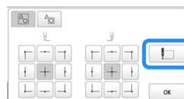
→ La varilla de la aguja se coloca en la esquina inferior izquierda del patrón. El bastidor de bordado se mueve para que la aguja quede colocada correctamente.
