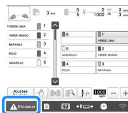
→ El botón de "inicio/parar" cambia de iluminado en rojo (máquina bloqueada) a parpadeando en verde (máquina desbloqueada), y la máquina está lista para comenzar a bordar.
