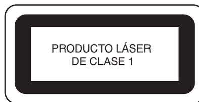
El haz láser emitido por la unidad láser instalada en esta máquina está limitado a una salida a un nivel seguro. No obstante, la máquina contiene una longitud de onda de 6 milivatios y 630-640 nanómetros, 6-12 grados en el ángulo de divergencia en paralelo, 28-40 grados en el ángulo de divergencia perpendicular y diodos láser InGaAlP. Por lo tanto, pueden producirse lesiones oculares si la máquina se desmonta o modifica.
