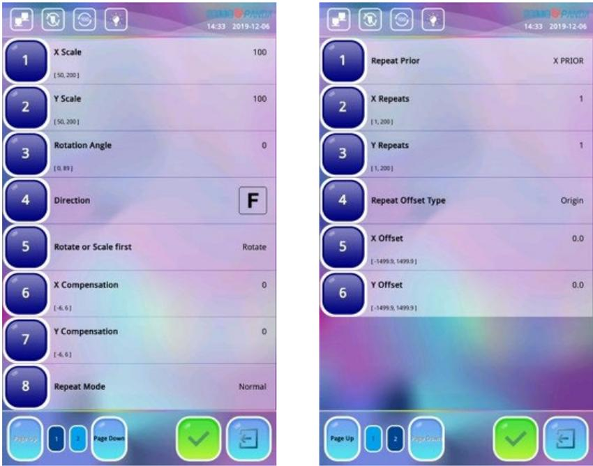
(1) **Escala X Y:** Este parámetro controla la relación de zoom del patrón en las direcciones X (horizontal) e Y (vertical), y puede aumentar/reducir la escala del patrón en un porcentaje.
