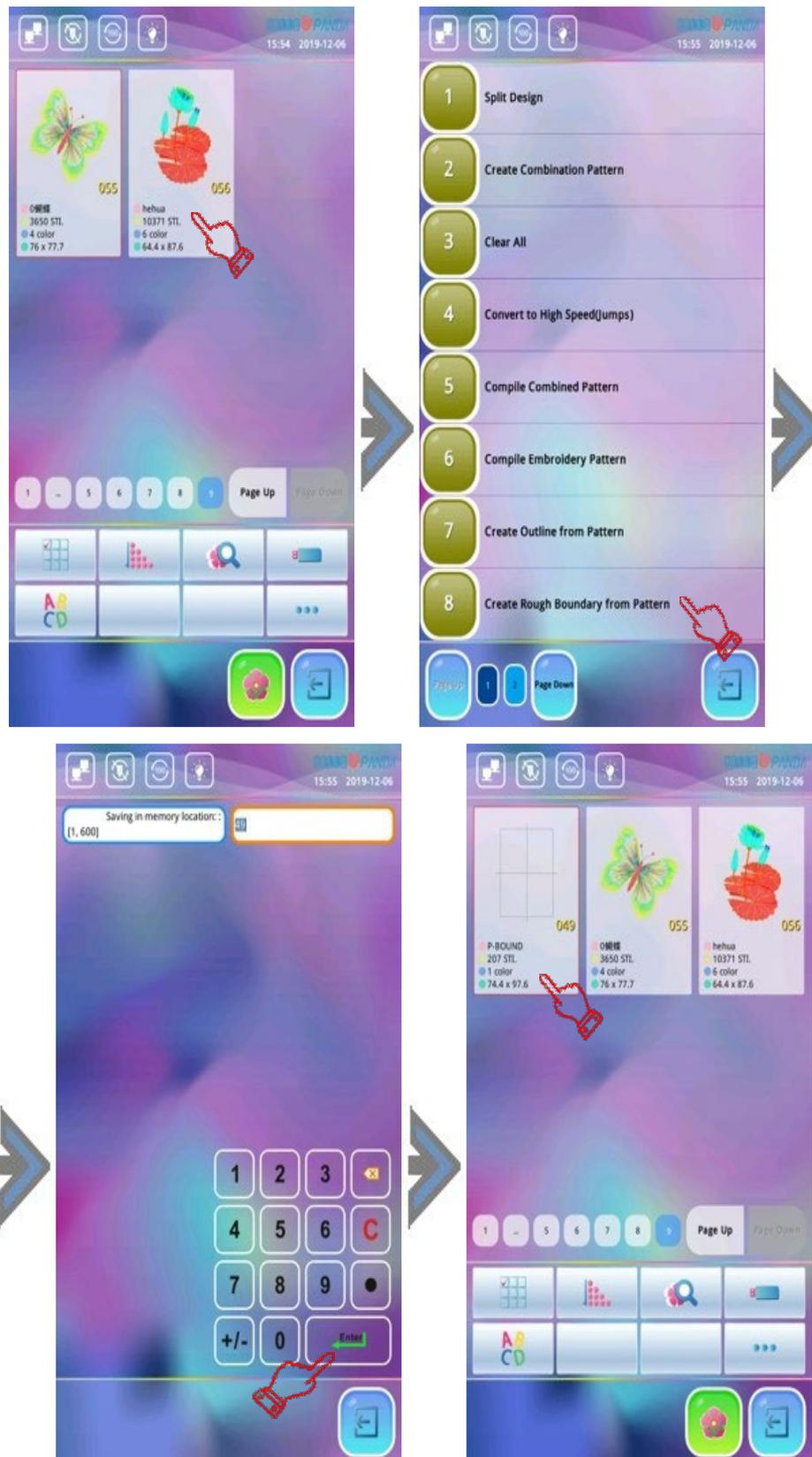
(Nota: Si el patrón original es un patrón de repetición o un patrón de combinación, el borde del patrón generado generará los correspondientes límites rugosos múltiples basados en el borde de un único diseño).
