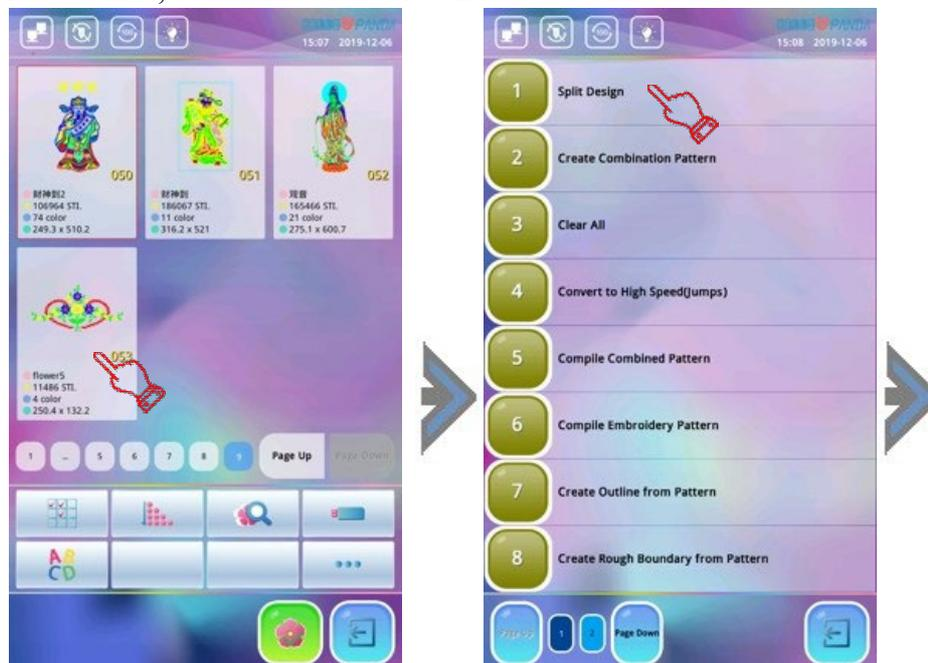
2. Utilice los iconos numéricos para introducir el número de puntada del número de división, y el nombre del diseño a dividir y el número del segundo diseño, y pulse la tecla “” para confirmar. (Nota: El sistema proporcionará automáticamente el número de diseño mínimo
