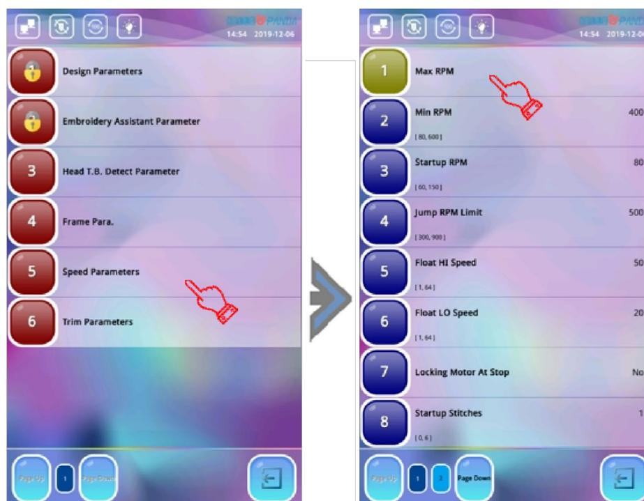
2. Presione el ítem "Max RPM" o "Min RPM" de acuerdo a las necesidades del usuario para ajustar la velocidad de rotación específica.
