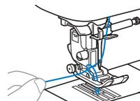
**7** Tire del hilo de la bobina, páselo por debajo del pie prensatela y tire de él unos 10 cm (4 pulg.) hacia la parte trasera de la máquina, haciéndolo coincidir con el hilo superior.
