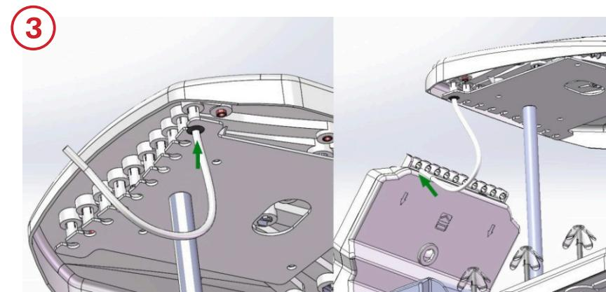
Insertar los tubos uno a uno colocando un extremo en la parte de abajo de la placa superior ajustada en el paso anterior, y el otro extremo en la parte superior del frontal de la bordadora.
