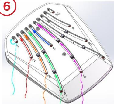
Colocar el hilo por las ranuras de la placa de hilos superior, tal como podemos verlo en la figura 6.
