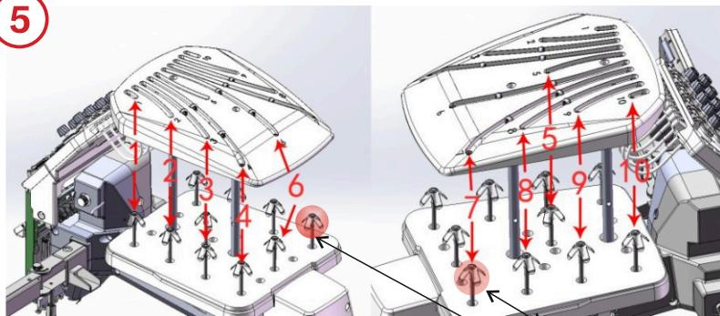
Colocar los hilos en las filetas (de ser necesario quitaremos el topé plástico), y llevaremos el hilo por dentro de los orificios hacia arriba de la tapa colocada en el paso 2. Debemos verificar que el hilo siga el camino necesario, ya que podría provocar problemas al momento de bordar.
