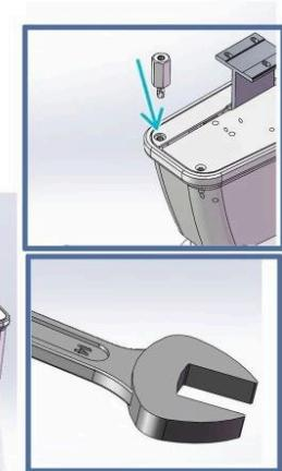
Utilice una llave fija #14 para atornillar las dos tuercas hexagonales en los orificios de la bancada
