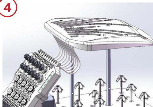
Repetir el paso 3 hasta colocar los 10 tubos transparentes.
