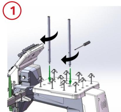
Inserte un destornillador (o cualquier otra varilla) en el orificio del medio de la columna de soporte de la fileta de hilos y girelo hacia la derecha para apretar.
