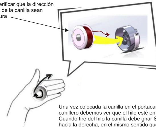
Una vez colocada la canilla en el portacanillas o canillero debemos ver que el hilo esté en la parte superior. Cuando tire del hilo la canilla debe girar SIEMPRE hacia la derecha, en el mismo sentido que las agujas del reloj.
