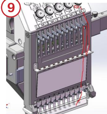
Enhebrar la parte delantera del frontal de la máquina. Siguiendo en cada hilo exactamente las mismas indicaciones.
