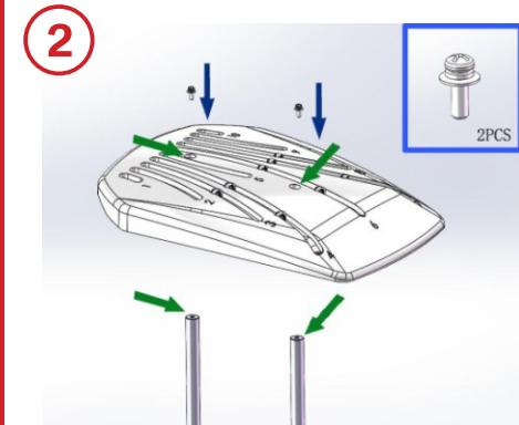
Coloque la placa superior de hilos alineada con las dos roscas de las columnas de soporte. Atornillar ambos tornillos hexagonales M5 y ajuste, siempre hacia la derecha.
